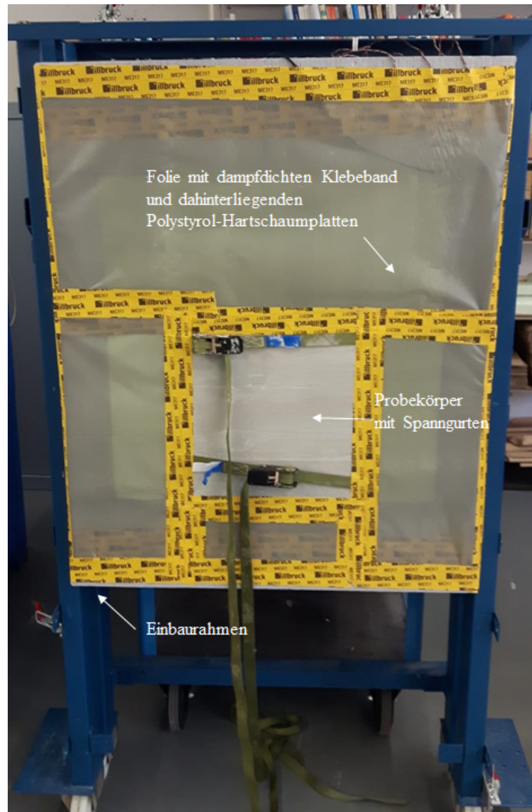
Abb. 63: Abgedichteter Probekörper im Einbaurahmen
